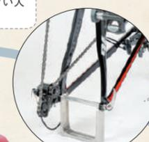
エンド金具を動かさないようにしっかりと取り付けます。ワイヤーが地面に着かない角度に調整することが肝心。チェーンハンガーでチェーンを引っ張る。
